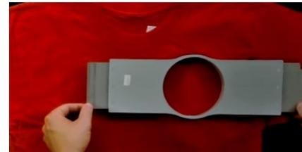
8. Drücken Sie die Einspannhilfe herunter, so dass sie einrastet. Achten Sie darauf, auf den Ring zu drücken und nicht auf die Arme. Durch Drücken der Arme können diese brechen oder die Einspannhilfe kann sich verbiegen.
