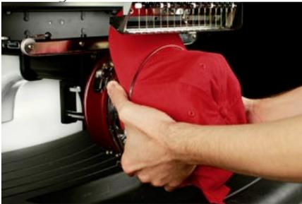
3. Damit werden auch die rechteckigen Öffnungen am Rand des Rahmens an den federbelasteten Verriegelungsklemmen der Führung ausgerichtet.
