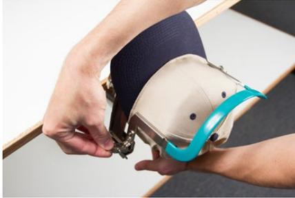
11. Lösen Sie die Rückseite der Kappe und halten Sie gleichzeitig das Kappenrahmenband um das Schweißband herum nach unten. Befestigen Sie den Bandverschluss über den Haken an der Auflage. Ziehen Sie die Lasche, um den Kappenrahmen zu verriegeln.
