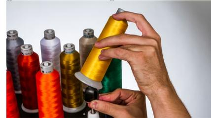
2. Führen Sie den Faden mit der Einfädelhilfe aus dem Bediener set oder mit Druckluft durch das Fadenrohr von der Rolle zum kleinen Loch hinter der Fadenzuführung.
