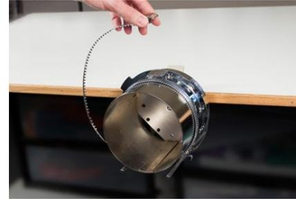
3. Legen Sie eine entsprechende Verstärkung über die Schablone und die Zahnung des Kappenrahmens. Stellen Sie sicher, that die Verstärkung ausreichend lang ist, um den gesamten Stickbereich zu tragen. Am einfachsten ist es, eine Verstärkung zu verwenden, die lang genug ist und bis zu den Ständern an der Unterseite des Kappenrahmens reicht.
