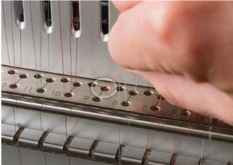
6. Führen Sie den Faden um den Fadensensor von hinten nach vorn und dann nach oben durch das vordere Loch der Mittelfadenführung.
