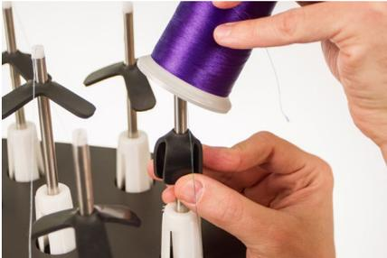
3. Beim Lösen des Garnstabilisators wird dieser im Inneren der Rolle gedehnt und stabilisiert die Fadenrolle.
