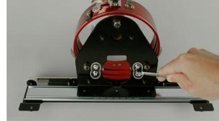
4. Entfernen Sie den Kappenstützflügel. Schwenken Sie ihn beim Entfernen leicht von links nach rechts und wieder zurück. Dies lockert jeden Fuss an der Rolle.
