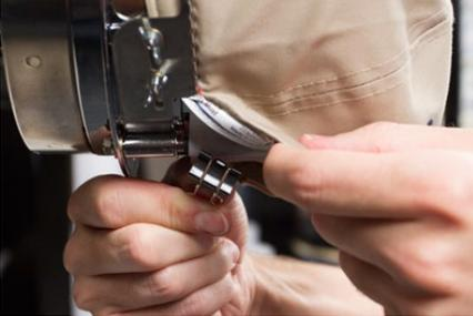
15. Glätten Sie beim Sticken an den Seiten der Kappe das Kappenmaterial nach hinten und über die Klammerständer an beiden Seiten. Kerben Sie das Kappenmaterial entlang der Klammerständer ein.
