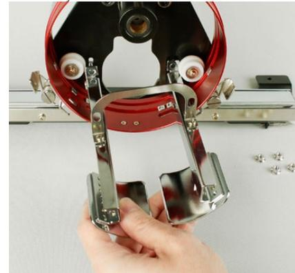
5. Montieren Sie die vier Schrauben wieder an den Abstandsbolzen mit Gewinde, um sie nicht zu verlieren.
