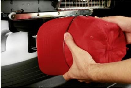
2. Drehen Sie den Schirm zurück nach oben, damit sich dieser hinter dem Nadelgehäuse befindet und die Positionierungslasche auf der Führung sich mit dem Einschnitt im Rahmen deckt.
