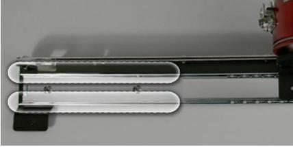
4. Bringen Sie eine dünne Schicht Nähmaschinenöl an den Rillen des Gleitlagers an.
