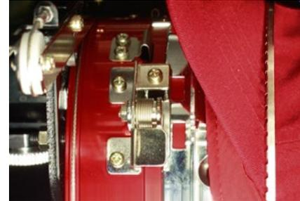
4. Drücken Sie den ausgerichteten Rahmen zur Führung hin, bis die drei (3) federbelasteten Verriegelungsklemmen einrasten. Es kann hilfreich sein, hinter die Führung zu greifen und Ihre Hände zu schliessen, um die Kappe wie abgebildet einzuschieben.
