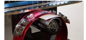
4. Bei zu kleinem oder zu grossem Spalt muss die Führung eingestellt werden (s. u.).
