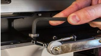
Der rote Führungsring sollte leicht über den unteren Arm der Maschine gleiten. Zwischen den Ring und den unteren Arm sollten eine oder zwei Visitenkarten passen. Der Abstand sollte aber nicht grösser sein. Bei falschem Abstand zwischen dem Ring und dem unteren Arm oder wenn die Führung nicht installiert werden kann, muss eine Neueinstellung vorgenommen werden. Im Abschnitt zu den Einstellungen erhalten Sie Hinweise zum Prüfen und zum Einstellen.
