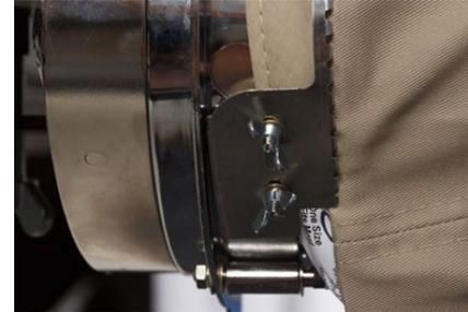
9. Fahren Sie mit dem Anbringen des Bandes um die Vorderseite der Kappe herum fort. An der Vorderseite der Kappe muss die Zahnung des Bandes in der Naht zum Schirm positioniert sein.
