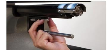
9. Befestigen Sie den Hakenschutz, indem Sie ihn in Position schieben und die beiden kleinen Schrauben mit einem 2-mm-Inbusschlüssel festziehen.
