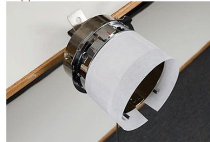
*Manchmal ist es einfacher, Einfassklammern zu verwenden, um die Verstärkung festzuhalten, während die Kappe eingespannt wird. Der Nachteil dabei ist, dass die Klammern von der Innenseite der Kappe heraus entfernt werden müssen, wenn das Einspannen beendet ist. Dies ist nicht immer einfach. Das Klammern der Verstärkung vor dem Einspannen der Kappe ist optional.*
