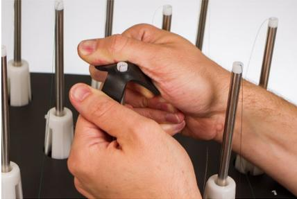
2. Ziehen Sie beim Bestücken der Maschine mit der Rolle den Garnstabilisator zum Fadenrohr hin zusammen.
