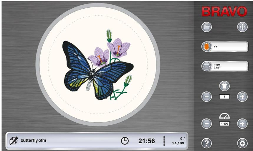
Der Hauptbildschirm besteht aus drei Bereichen. Der grösste Bereich dient der Vorschau des Musters in der gewählten Einspannhilfe. Hier erhält der Benutzer eine Ansicht der Positionierung in der Einspannhilfe sowie der Farbwahl.
