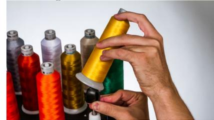
2. Der schwarze Garnstabilisator muss ggf. zusammengezogen werden, damit eine neue Rolle auf den Fadensitz eingesetzt werden kann. Befindet sich der Garnstabilisator zu niedrig am Fadenrohr, so kann die neue Fadenrolle möglicherweise nicht ausreichend fest am Garnplatz gelagert werden. Bewegen Sie in diesem Fall den Garnstabilisator nach oben am Fadenrohr und versuchen Sie es erneut.
