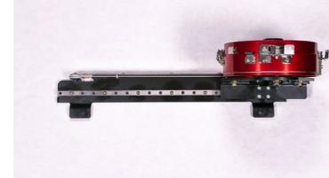
3. Reinigen Sie beide Seiten des freiliegenden Teils der Linearschiene mit einem sauberen Tuch.
