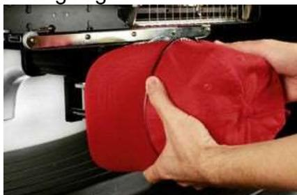
2. Ruotare il cappello intelaiato in senso orario di 90° in modo che la tesa sia dietro alla testa e che la linguetta di centratura posizionata sul driver sia allineata con la tacca del telaio.
