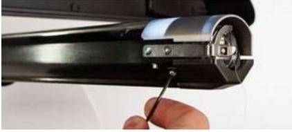
6. Allentare le manopole della barra di supporto del braccio a baionetta inferiore fino a quando le punte delle viti arrivano a filo alla barra di supporto.
