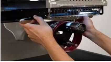
12. Utilizzando due viti a testa zigrinata usate per i bracci di supporto telaio, collegare la barra di supporto al pantografo X della macchina. Far coincidere i fori della barra con quelli più interni del pantografo. Stringere le viti con le dita poi utilizzare una chiave a L da 6 mm per serrare le viti. Non stringere troppo le viti in quanto sono progettate per rompersi prima che si possa causare un danno alle filettature del pantografo.
