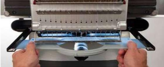
2. Far scorrere il telaio verso la parte posteriore della macchina fino a quando non scatta in posizione e le staffe sono completamente inserite nei bracci.
