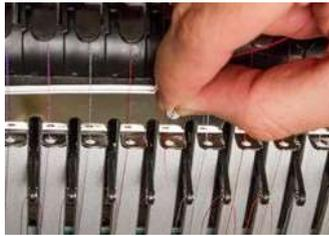
5. Posizionare il filo sulla guida centrale del coperchio sottostante nero e farlo passare all'interno del primo foro subito sotto. Dei tre fori, inserire il filo dall'alto attraverso il foro posteriore destra. Assicurarsi che il filo si trovi sul lato destro della leva tendifilo.
