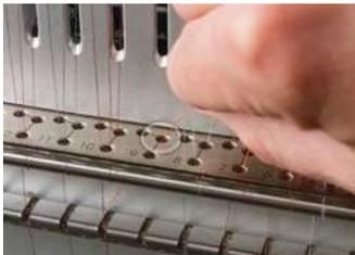
6. Portare il filo attorno al cilindro del sensore della rottura filo da dietro in avanti e inserirlo dal basso verso l'alto attraverso il foro anteriore della guida.
