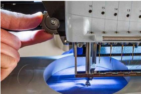
6. Ruotare l'ingranaggio con le dita per regolare l'altezza del piedino verso l'alto o verso il basso, se necessario.
