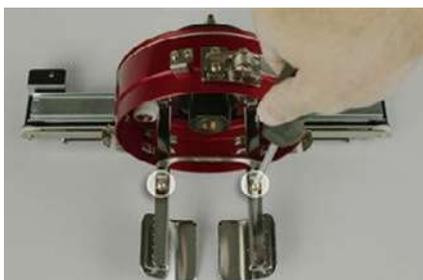
3. Rimuovere i 4 dadi che sono avvitati alle staffe di sostegno delle alette con una chiave esagonale di 7mm a tubo o aperta.
