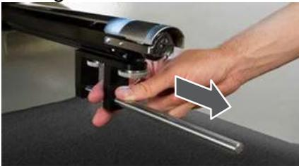
5. Rimontare il coperchio di protezione del crochet facendolo scorrere in posizione e stringere le due piccole viti con una chiave esagonale a L da 2 mm.
