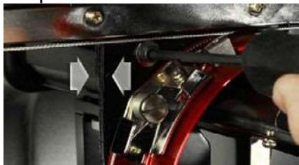
6. Stringere la vite di fissaggio opposta nel blocco di montaggio del cuscinetto.
