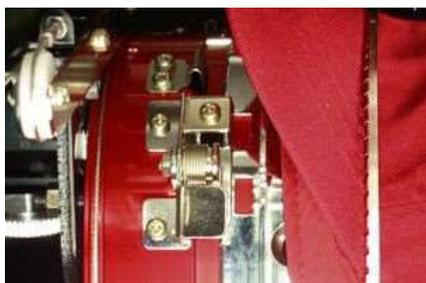
4. Con il telaio allineato, spingerlo con i pollici verso il dispositivo fino a quando i tre (3) morsetti di bloccaggio scattano in posizione. Può essere utile posizionare le altre dita dietro al cilindro del dispositivo per fare forza e chiudere le dita con i pollici per spingere il telaio verso il dispositivo, come nella foto.
