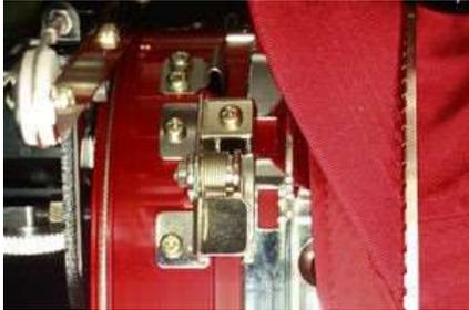
3. Ruotare il cappello intelaiato in modo che la tesa stia a 90° per consentire il passaggio di essa sotto gli aghi. Il telaio adesso può essere rimosso dalla macchina.
