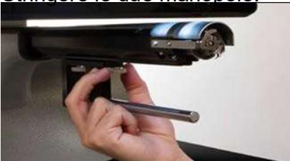
9. Rimontare il coperchio di protezione del crochet facendolo scorrere in posizione e stringere le due piccole viti con una chiave esagonale a L da 2 mm.
