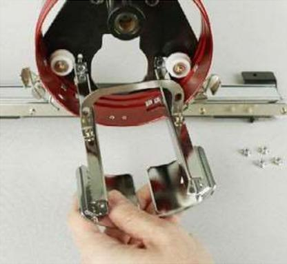
5. Avvitare i 4 dadi. Manteneteli leggermente allentati. Ciò permetterà un inserimento adeguato del gruppo di supporto delle ali con il braccio principale del crochet della macchina.
