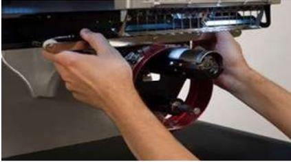
3. Rimuovere il coperchio di protezione del crochet allentando le viti su entrambi i lati del braccio inferiore con una chiave esagonale a L da 2 mm e trascinando il coperchio in avanti. Le viti non devono essere completamente rimosse.
