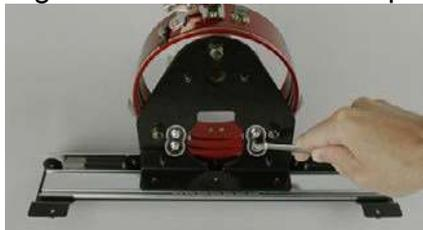
4. Rimuovere il gruppo di supporto delle alette. Ruotare leggermente il gruppo da sinistra a destra e viceversa durante la rimozione. Ciò contribuirà a facilitare l'uscita di ogni staffa attorno ai rulli bianchi.
