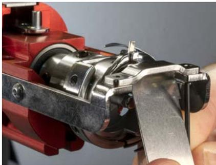
3. Passen Sie die Position der Hakenhalterung an die Anforderungen aus dem obigen Inspektionsverfahren an.
