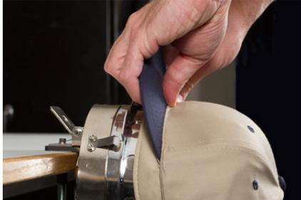
7. Ziehen Sie die Seite des Schweißbandes zum Kappenrahmen und nach unten. Glätten Sie eventuelle Falten an den Seiten der Kappe oder am Schweißband. Möglicherweise müssen Sie das Schweißband etwas falten, um den Verschlusshaken zu vermeiden. Dies erleichtert jedoch die Platzierung der Kappe auf dem Rahmen. Behalten Sie dabei den Stabilisator im Auge, um sicherzustellen, dass er noch drin ist.
