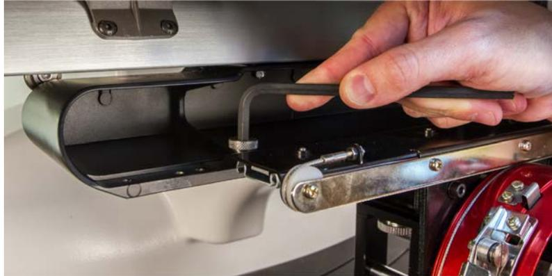
2. Schieben Sie die rote Treiberbaugruppe zu sich heran und vom Unterarm und der Stützwelle weg. Dies kann einfacher sein, wenn der Haltegriff der Maschine geschlossen ist.
