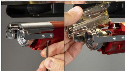
4. Entfernen Sie mit Druckluft oder einer Bürste sämtliche Fäden und Flusen aus dem Bereich.
