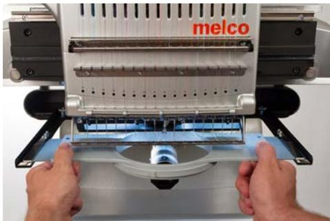
4. Kontrollieren Sie ob sich ein Teil des Textil zwischen Stickunterlage und Stichplatte befindet. Ist dies der Fall muss das entfernt werden. Ballonen Sie das Kleidungsstück um den zylindrischen Unterarm auf. Dadurch wird verhindert, dass andere Kleidungsstücke in die Unterseite der Stickerei eingnäht werden.
