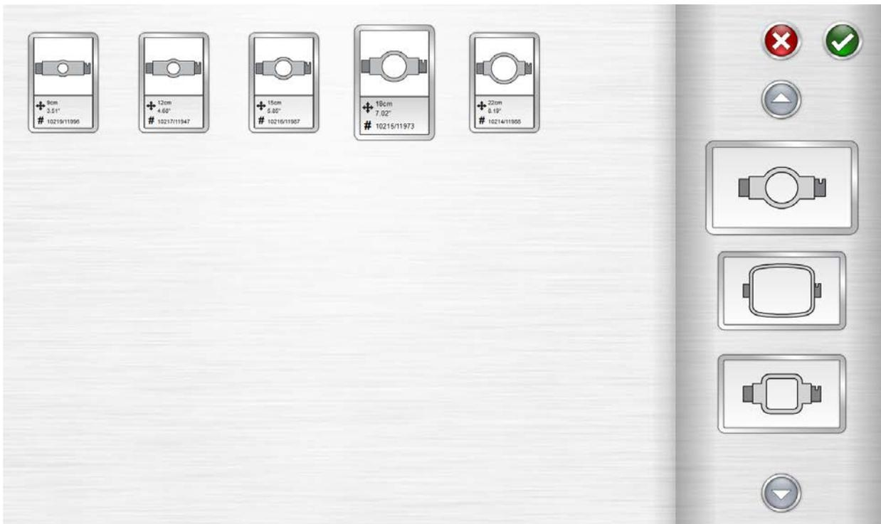
Auf diesem Bildschirm werden die Rahmenarten und -größen angezeigt. Die Auswahl des geeigneten Rahmens ist entscheidend dafür, dass die Rahmenbegrenzungen richtig funktionieren.
