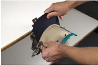
8. Zentrieren Sie die Naht und ebnen Sie die Kappe bestmöglich. Damit wird die Kappe gegen den Rahmen herunter- und dichtgezogen.
