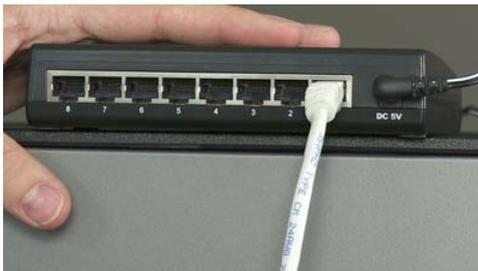
4. Verbinden Sie nun das Ende eines weiteren Kabels mit einem anderen Anschluss am Switch.
