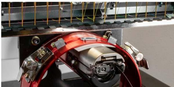
4. Bei zu kleinem oder zu grossem Spalt muss die Führung eingestellt werden (s. u.).
