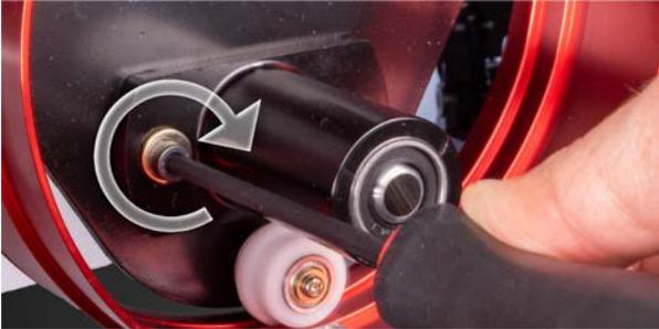
7. Ziehen Sie die zweite obere Schraube fest, mit der die Halterung befestigt ist, und dann die zweite untere Schraube, mit der die Lagermontagehalterung befestigt ist. Durch sternförmiges Anziehen dieser vier Schrauben erzielen Sie die besten Ergebnisse. Anschließend die Visitenkarte entnehmen.
