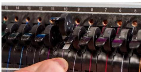
5. Ziehen Sie den Faden nach unten zur Mittelfadenführung. Schieben Sie den Faden bei den drei Löchern von der Oberseite her durch das hintere rechte Loch. Stellen Sie sicher, dass sich der Faden an der rechten Seite des Aufnahmehebels befindet.
