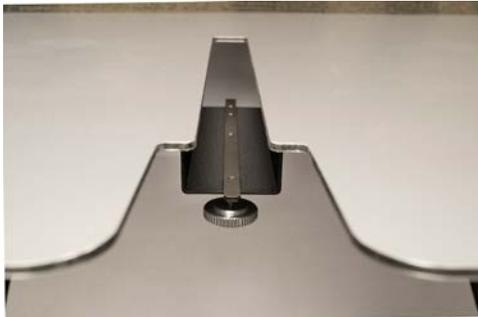
4. Schieben Sie den Tisch an seinen Platz, während Sie die T-Mutter in den T-Kanal an der Unterseite des Unterarms der Maschine einsetzen.
