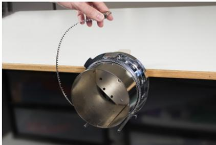
3. Legen Sie eine entsprechende Verstärkung über die Schablone und die Zahnung des Kappenrahmens. Stellen Sie sicher, dass die Verstärkung ausreichend lang ist, um den gesamten Stickbereich zu tragen. Am einfachsten ist es wahrscheinlich, einen Stabilisator zu verwenden, der lang genug ist, um die Pfosten an der Unterseite des Kappenrahmens zu erreichen.
