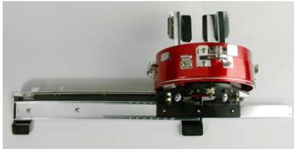
3. Reinigen Sie den freiliegenden Teil der freiliegenden Gleitlagernut mit einem sauberen Tuch.
