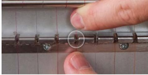
10. Führen Sie den Faden von vorn nach hinten in das Nadelöhr ein. Ein geschnittenes Fadenende kann das Durchführen des Fadens durch das Öhr erleichtern.
