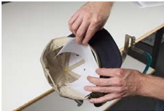
4. Schieben Sie die vorbereitete Kappe auf den Kappenrahmen. Der Kappenschirm muss dabei nach oben zeigen und der Rahmen zur Innenseite der Kappe gerichtet sein. Stellen Sie sicher, dass das Schweissband aus der Kappe herausgeklappt ist.
