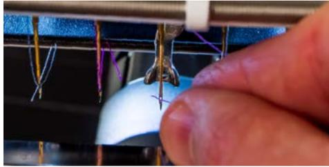
11. Richten Sie den Faden am kleinen V-Ausschnitt in der Abdeckung der Fadenzuführung aus.
