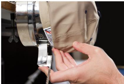
8. Wenn sich die linke Seite der Kappe innerhalb des Riemenscharniers befindet, schwingen Sie den Riemen nach oben und über die Kappenkrempe. An der Seite der Kappe sollten die Zähne des Riemens knapp über der Naht liegen, die das Schweißband mit der Kappe verbindet.
