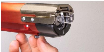
3. Entfernen Sie die Stichplatte, indem Sie die beiden Inbusschrauben entfernen, mit denen sie befestigt ist.
