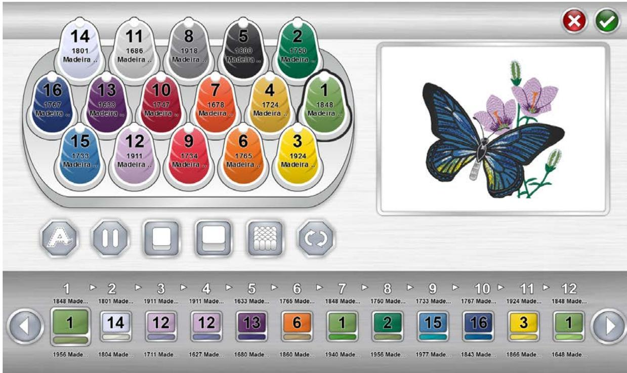
In der Farbreihenfolge werden zwei Farben für einen Farbblock angezeigt. Der untere Block beinhaltet die Farbe welche im Design bestimmt wurde und der obere Block die Farbe welche gestickt wird.
