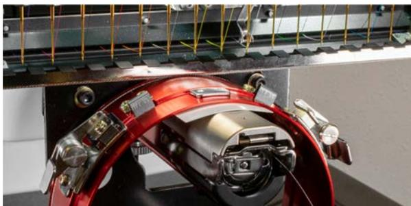
5. Achten Sie darauf, dass die Kanten der beiden schwarzen Halterungen ausgerichtet sind, und ziehen Sie eine der oberen Schrauben fest.
