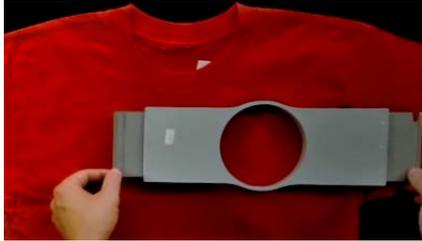
8. Drücken Sie die Einspannhilfe herunter, so dass sie einrastet. Achten Sie darauf, dass Sie auf den Ring und nicht auf die Bügel drücken. Durch Druck auf die Arme kann der Reifen seine Form verbiegen oder brechen.
