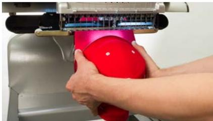
3. Dadurch werden auch die rechteckigen Löcher entlang der Rahmenkante mit den federbelasteten Verriegelungsklemmen am Treiber ausgerichtet.
