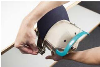
10. Halten Sie den Riemen des Kappenrahmens nach unten um das Schweißband herum gedrückt, lassen Sie die Rückseite der Kappe los und befestigen Sie die Riemenverriegelung über dem Haken an der Halterung. Ziehen Sie an der Lasche, um den Kappenrahmen zu verriegeln.
