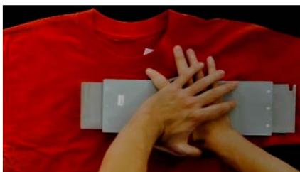
9. Stellen Sie nach dem Einspannen des Materials sicher, dass das Kleidungsstück glatt, eben und straff ist. Ist das Kleidungsstück locker, muss die Einspannhilfe entfernt und die Spannung der Einspannhilfe oder das Einspannverfahren geändert werden.
