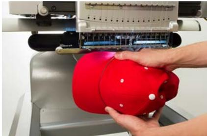
2. Drehen Sie die Banknote wieder nach oben, sodass sie sich hinter dem Nadelgehäuse befindet und die Positionierungsflasche am Treiber mit der Kerbe im Rahmen übereinstimmt.
