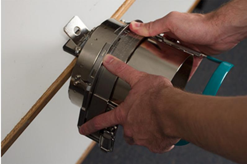
2. Entriegeln Sie den Kappenrahmen und schwenken Sie den Rahmen auf und nach rechts. Ziehen Sie dazu die Lasche vom Rahmen weg. Drücken Sie dann den Rand des Rahmens herunter, um den Verschluss vom Haken zu lösen. Den Rahmen aufklappen.
