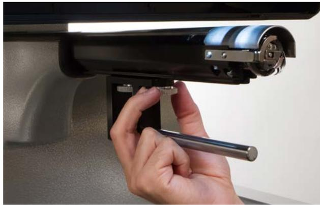
9. Ziehen Sie die Schrauben mit einem 3-mm-Inbusschlüssel eine Vierteldrehung weiter an.
