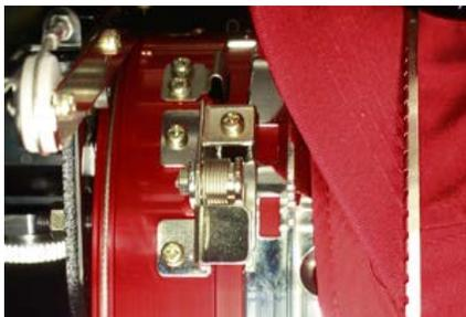
4. Drücken Sie den ausgerichteten Rahmen zur Führung hin, bis die drei (3) federbelasteten Verriegelungsklemmen einrasten. Es kann hilfreich sein, die Rückseite des Schraubendrehers zu greifen und den Griff zu schließen, um die Kappe wie abgebildet an die richtige Stelle zu drücken.
