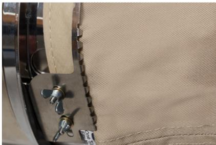
9. Führen Sie den Riemen weiter um die Vorderseite der Kappe herum. Auf der Vorderseite der Kappe müssen die Zähne des Riemens in die Naht für den Schirm fallen.
