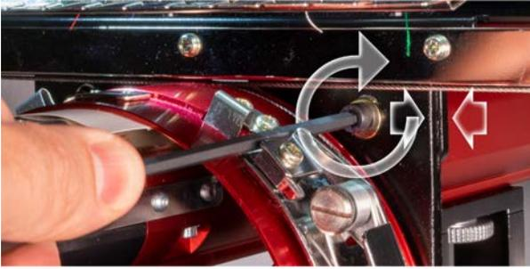
6. Ziehen Sie die gegenüberliegende Schraube fest, mit der der Lagermontageblock befestigt ist.
