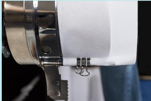
4. Schieben Sie die vorbereitete Kappe auf den Kappenrahmen. Der Kappenschirm muss dabei nach oben zeigen und der Rahmen zur Innenseite der Kappe gerichtet sein. Der Schirm muss gegen den Schirm-Anschlag des Rahmens gedrückt werden. Die Zentriermarkierung auf dem Geldscheinstopper kann als Orientierung dienen.
