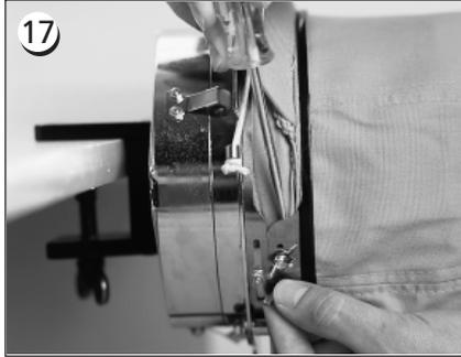
Lâchez les écrous à oreilles sur la ceinture, faites encliqueter et fermez la boucle... puis poussez en bas sur la ceinture au-dessus des écrous à oreilles avec un outil dur. Utilisez de pression MODEREE pour faire cela. Resserrez les écrous à oreilles.
