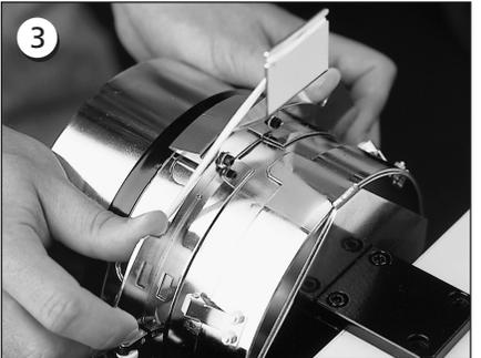
Ahora empujen Vds. el bastidor para gorras sobre el dispositivo de tensado, asegurándose de que el elemento de sujeción del dispositivo de tensado engatilla en la entalladura del bastidor para gorras y que el bastidor para gorras se desliza en posición estable, debajo de las dos abrazaderas de rodillo.
