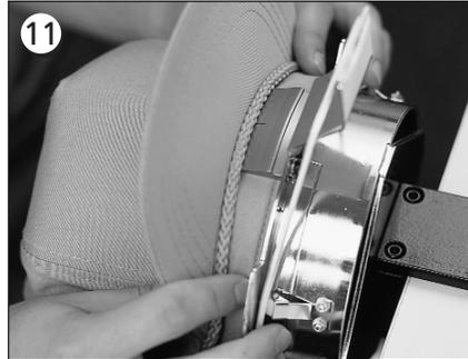
Ahora pongan Vds. la gorra en el bastidor para gorras. La badana tendría que estar debajo del elemento de sujeción y el borde tendría que estar centrado y indicando hacia arriba.
