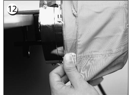
Tiren la parte lateral de la badana hacia el bastidor para gorras y hacia abajo.
