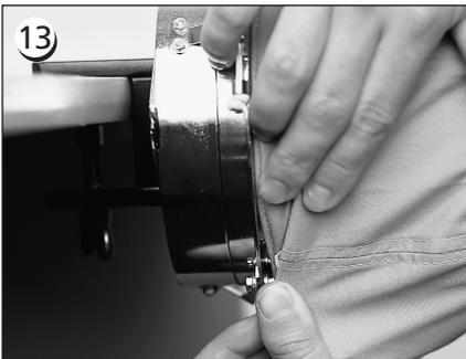
Nivelen Vds. cualquier "irregularidad" de la badana doblándola por encima de y hacia el bastidor.
