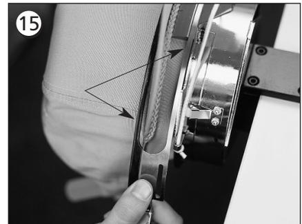
Cierren Vds. la cinta metálica, asegurándose de que un lado de la cinta entra en la ranura del dispositivo de sujeción ... y que el otro lado está bien colocado a lo largo del borde.
