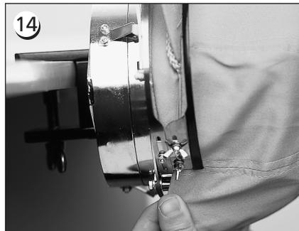
Para sujetar la badana, giren la cinta metálica hacia arriba y sobre la badana y el borde de la gorra.
