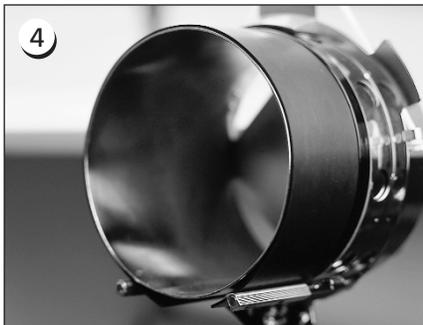
Para obtener una calidad de bordado óptima utilicen Vds. la cinta elástica de goma: esta asegura una distancia y una tensión del bastidor apropiadas. Tiren Vds. la cinta sobre el dispositivo de tensado.
