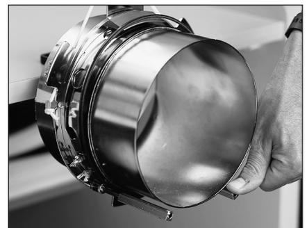
Si las abrazaderas están encorvadas y están tocando el dispositivo de tensado, doblenlas de nuevo hacia atrás en su posición.
