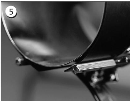
... situando las extremidades ENTRE estas abrazaderas y el dispositivo de tensado del bastidor para gorras.
