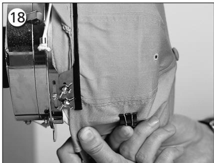
Tiren los soportes del borde elástico sobre el borde de la gorra, hacia la parte delantera. Alicen Vds. los pliegues de la gorra por medio de una tensión ligera. Para sujetar el material de la gorra, sujeten Vds. dos abrazaderas ...
