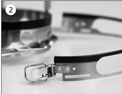
El bastidor para gorras tiene una cinta metálica con una hebilla en su extremidad. Asegurense de que esta hebilla está sujeta con tornillos en sus dos agujeros EXTERIORES, NO en los dos agujeros interiores.
