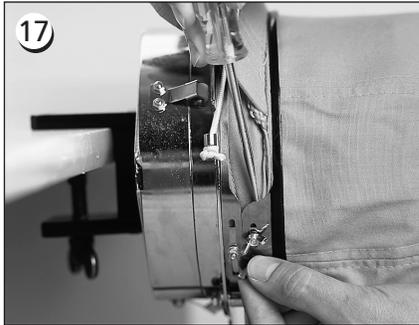
Desatornillen las tuercas de mariposa de la cinta, engatillen y cierren la hebilla .... luego empujen la cinta hacia abajo, por encima de las tuercas de mariposa con una herramienta resistente. Aprieten de manera MODERADA al efectuar esta operación. Atornillen de nuevo las tuercas de mariposa.
