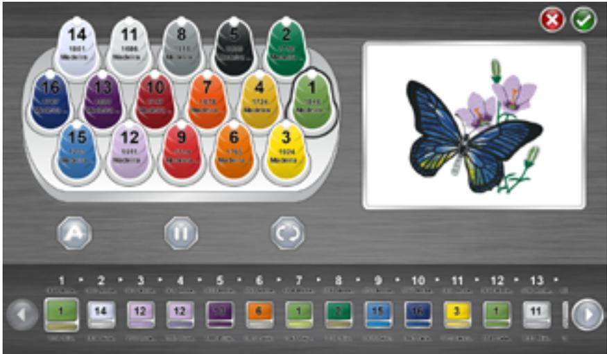
In der Farbreihenfolge werden zwei Farben für einen Farbblock angezeigt. Der untere Block beinhaltet die Farbe welche im Design bestimmt wurde und der obere Block die Farbe welche gestickt wird.
