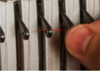
8. Führen Sie den Faden senkrecht nach unten durch das hintere linke Loch in der Mittelfadenführung.
