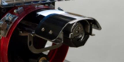
10. Stellen Sie eine Seite der Kappenunterstützung ein, bis sie die Visitenkarte und die Stichplatte berührt. Ziehen Sie die beiden Muttern an der Rückseite der Führung an.
