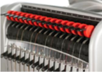
4. Ziehen Sie den Faden aus dem Loch und platzieren Sie ihn unter der Andruckrolle. Führen Sie den Faden nach unten durch die Oberfadenführung.
