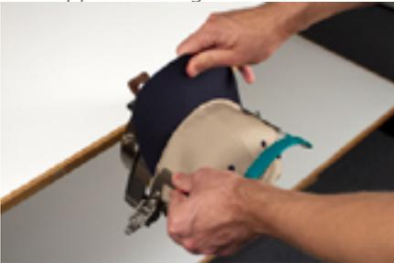
9. Ziehen Sie vorsichtig an der Rückseite der Kappe. Damit wird die Kappe gegen den Rahmen herunter- und dichtgezogen.
