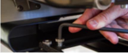
*Wenn die Arme der Einspannhilfe nicht entfernt werden, wird die Weitwinkelführung beim Sticken mit den Armen zusammenstossen.*
