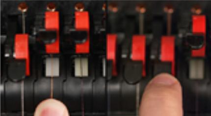
9. Falls erforderlich, kann der Faden durch die Rückholfeder an der Vorderseite der Unterfadenführung oder mit dem Greifer in Position gehalten werden. Halten Sie Ihre Hände aus dem Weg und drücken Sie die Einstellungen- und Mitteltaste des Tastenfeldes gleichzeitig, um den Greifer zu schliessen und den Faden in den Halter hinter den Nadeln zu bewegen.
