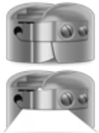
Blasen Sie nach Reinigung des Spulengehäuses dieses mit Druckluft aus. Es wird empfohlen, die Spulenspannung zu prüfen.
