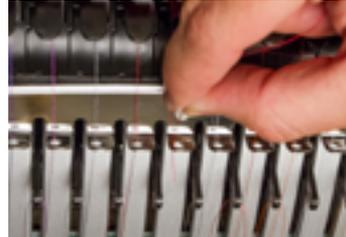
5. Ziehen Sie den Faden nach unten zur Mittelfadenführung. Schieben Sie den Faden bei den drei Löchern von der Oberseite her durch das hintere rechte Loch. Stellen Sie sicher, dass sich der Faden an der rechten Seite des Aufnahmehebels befindet.
