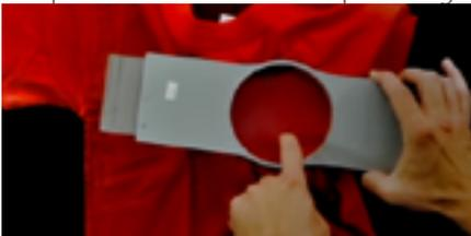
10. Prüfen Sie die Rückseite des eingespannten Teils. Vergewissern Sie sich, dass sich keine Falten oder andere Teile des Kleidungsstücks in der Einspannhilfe befinden.
