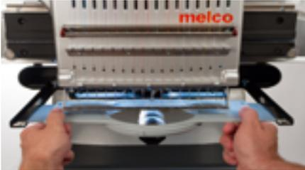
2. Schieben Sie den Stickrahmen unter die Klammern bis die Klammer einschnappt..
