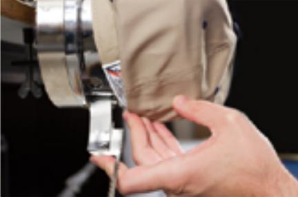
8. Befindet sich die linke Seite der Kappe innerhalb des Scharnierbandständers, klappen Sie das Band hoch und über den Kappenrand. An der Seite der Kappe muss die Zahnung des Bandes knapp über der Naht positioniert sein, die das Schweissband an der Kappe befestigt.
