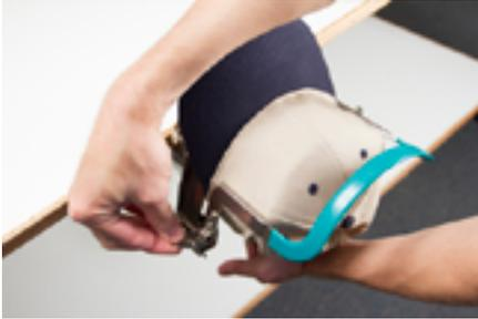
11. Lösen Sie die Rückseite der Kappe und halten Sie gleichzeitig das Kappenrahmenband um das Schweissband herum nach unten. Befestigen Sie den Bandverschluss über den Haken an der Auflage. Ziehen Sie die Lasche, um den Kappenrahmen zu verriegeln.
