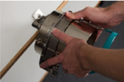
2. Entriegeln Sie den Kappenrahmen und klappen Sie den Rahmen nach rechts auf.
