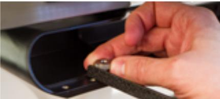
4. Stellen Sie sicher, dass der Ausschnitt vorne beim Rahmen auf der rechten Seite ist. Setzen Sie den Rahmen ein indem Sie den Rahmen unter die Klammern schieben. Schieben Sie die Rahmen bis zum Punkt an dem die Klammern einschnappen.
