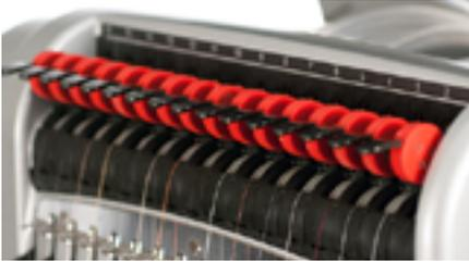
8. Richten Sie danach den Faden unter der Andruckrolle aus und drücken Sie die Andruckrolle herunter.
