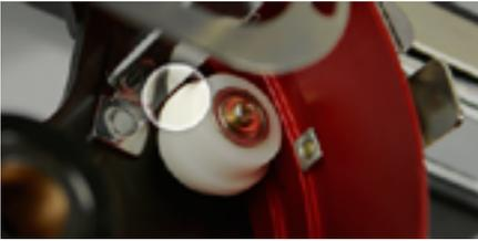
12. Ziehen Sie die beiden Kreuzschlitzschrauben an der Verbindungsklammer an.
