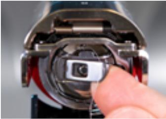
Das Spulengehäuse kann vom unteren Arm der Maschine mittels des Öffnungshebels am Spulengehäuse entfernt werden.
