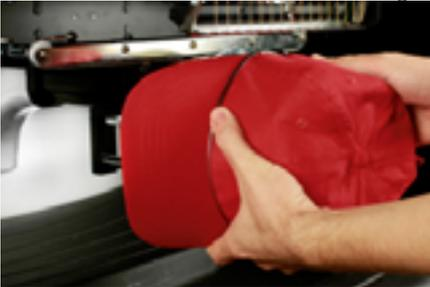
2. Drehen Sie den Schirm zurück nach oben, damit sich dieser hinter dem Nadelgehäuse befindet und die Positionierungsglasche auf der Führung sich mit dem Einschnitt im Rahmen deckt.
