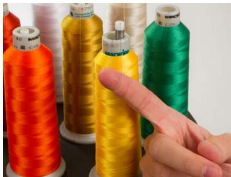
4. Binden Sie das Ende des alten Fadens mit einem Kreuzknoten an das Ende des neuen Fadens.
