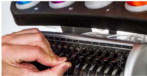
6. Richten Sie danach den Faden unter der Andruckrolle aus und drücken Sie die Andruckrolle herunter.
