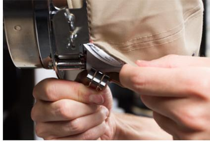
15. Wenn Sie an den Seiten der Kappe nähen, glätten Sie das Kappenmaterial nach hinten und über die Clippfosten auf beiden Seiten. Drücken Sie das Kappenmaterial entlang der Clippfosten ein.
