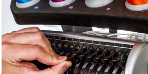
4. Ziehen Sie den Faden aus dem Loch und platzieren Sie ihn unter der Andruckrolle. Führen Sie den Faden nach unten durch die Oberfadenführung.
