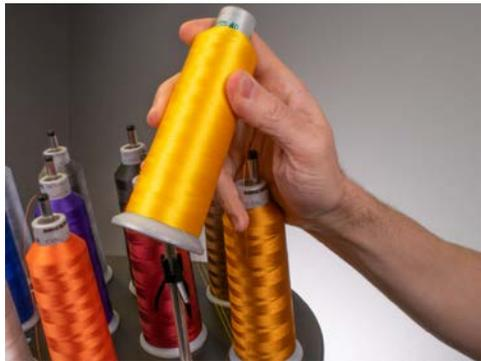
2. Führen Sie den Faden mit der Einfädelhilfe aus dem Bedienerset oder mit Druckluft durch das Fadenrohr von der Rolle zum kleinen Loch hinter der Fadenzuführung.
