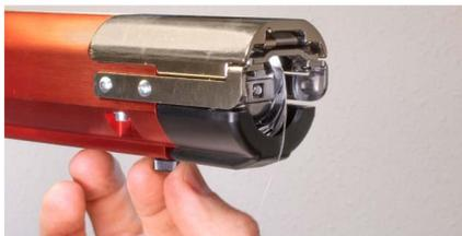
3. Entfernen Sie die Stichplatte, indem Sie die beiden Inbusschrauben entfernen, mit denen sie befestigt ist.
