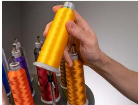
2. Ziehen Sie das Fadenrohr um 1.5cm bis 2.5cm über die Rolle heraus. Wird das Fadenrohr nicht um 1.5cm bis 2.5cm über die Rolle herausgezogen, so kann dies zu häufigen Fadenrissen führen.
