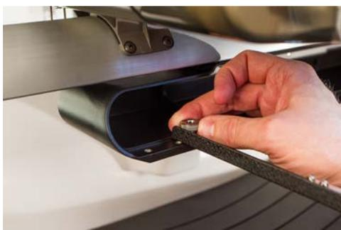
4. Installieren Sie einen Reifen, indem Sie die seitlichen Halterungen des Reifens unter die Federklammern an den Stützarmen schieben. Schieben Sie den Rahmen zur Rückseite der Maschine, bis er einrastet und die Halterungen vollständig unter den Federklammern sitzen. Achten Sie darauf, dass sich die Schlitzhalterung rechts befindet, wenn Sie auf die Maschine blicken. Die Stützarme bewegen sich noch etwas.
