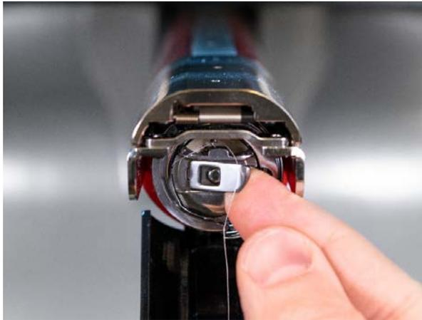
2. Entfernen Sie den Drehgreiferschutz, indem Sie die Flügelschraube lösen, mit der der Greiferschutz befestigt ist, und ihn von der Maschine wegschieben.
