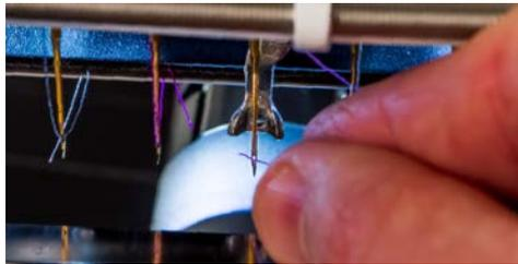
11. Richten Sie den Faden am kleinen V-Ausschnitt in der Abdeckung der Fadenzuführung aus.
