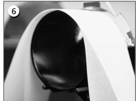
Un materiale di supporto appropriato può essere messo adesso intorno alla striscia elastica di gomma. Il materiale di supporto si trova sul lato ESTERNO dei morsetti e viene spinto al di SOTTO dell'elemento di fissaggio. Potete usare parecchi strati di materiale di supporto.
