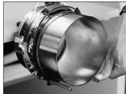
Se i morsetti sono curvati e se stanno toccando il dispositivo di serraggio, ricurvateli di nuovo nella loro posizione.
