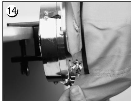
Pour arrêter le ruban de sueur, pivotez la ceinture métallique en haut et sur le ruban de sueur et le bord de la casquette.
