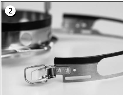
Le cadre casquette a une ceinture métallique avec une boucle à la fin. Assurez-vous que cette boucle sera bien vissée dans les trous EXTERIEURS, et NE PAS dans les trous intérieurs.
